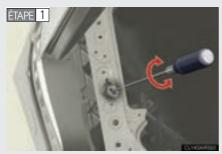
Tournez la vis A dans l'un ou l'autre sens au moyen d'un cruciforme tournevis (empreinte Phillips).
