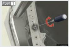
Tournez la vis A dans l'un ou l'autre sens au moyen d'un tournevis cruciforme (empreinte Phillips).
