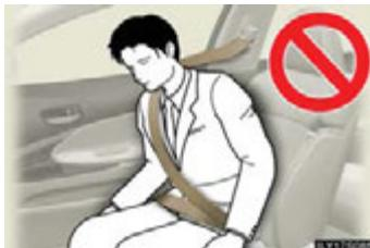
● Ne vous appuyez pas sur la portière ou sur le longeron du toit, ni sur les montants avant, latéraux ou arrière.
