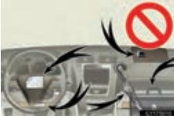
● Ne fixez et n'appuyez rien sur le tableau de bord, le rembourrage de volant ou la partie inférieure du bloc d'instrumentation. Ces objets peuvent se transformer en projectiles lorsque les coussins gonflables SRS du conducteur, du passager avant ou de protection des genoux se déploient.
