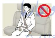
N'utilisez pas la ceinture de sécurité centrale de la troisième rangée de sièges si l'une des boucles est retirée. Fixer une seule boucle pourrait occasionner des blessures graves, voire mortelles, en cas de freinage brusque ou de collision.
