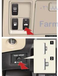
To open the trunk from inside the cabin, simply press the trunk opener. تلفن شبانه روزی: ۲۰۰۵
